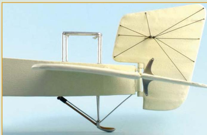
**33** Просверлите в верхней грани фюзеляжа 4 отверстия диаметром 0,5 мм и вклейте в них стойки рамы.
