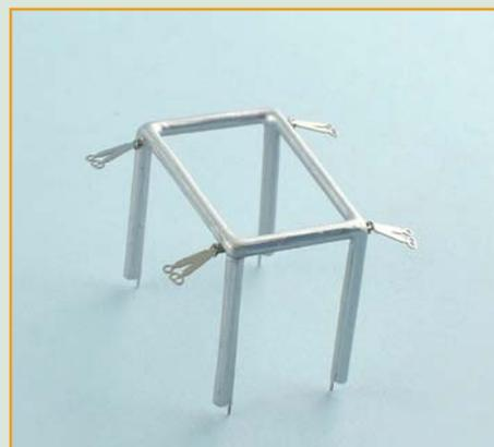
**32** Возьмите собранную раму хвостового оперения и четыре тандера F. Свяжите тонкой стальной проволокой тандеры с крепежными петлями по углам рамы, как показано на снимках. Затем срежьте излишки проволоки.
