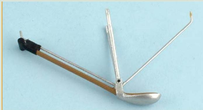
**30** Обмотайте хвостовик костыля и поддерживающего стержня леской, которая будет имитировать резиновый амортизационный шнур. Срежьте избыток лески и закрепите конец клеем.
