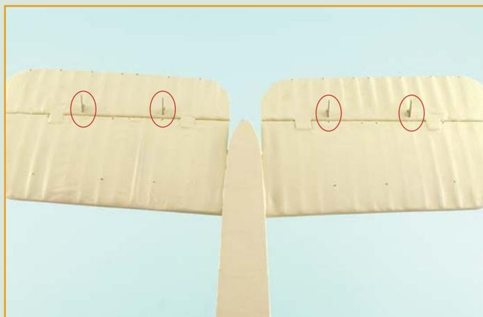
**20** Вклейте в отмеченные отверстия на рулях высоты сверху и снизу 8 стальных качалок. Они должны быть строго перпендикулярны рулю, а их наклон – обращен назад.
