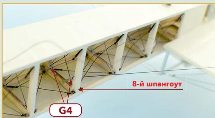
**43** Приклейте к бортам фюзеляжа в указанных местах детали G и H (направляющие рулевых тяг). Проделайте отверстия в бортах сквозь отверстия в этих деталях. Вклейте в отверстия достаточно длинные отрезки лески и сделайте из них проводку рулей по тому же принципу, как вы делали проводку элеронов на верхнем крыле. Если вы решили оставить фюзеляж без обшивки, то передние концы лесок надо прикрепить к деталям С4 на 8-м шпангоуте.
