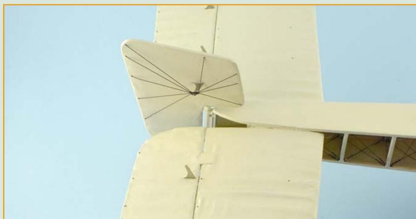
**25** Приклейте шарнир с рулем к задней кромке фюзеляжа, как показано на снимке.
