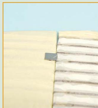
**3, 4** Сделайте прорезы в обшивке задней кромки стабилизатора, чтобы вставить в них отогнутые боковины петель навески руля. Затем приклейте руль к стабилизатору так же, как вы приклеивали элероны к крылу. Не забывайте, что он должен свободно отклоняться на петлях вверх и вниз.
