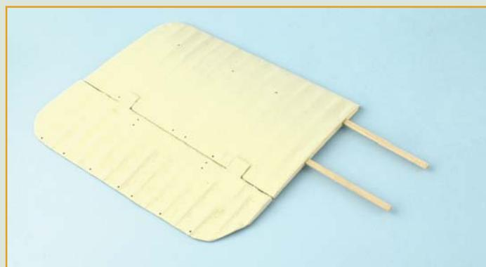
**17** Подгоните полученные отрезки к отверстиям в корневых нервюрах стабилизатора. При необходимости обработайте их наждачной бумагой, чтобы они вошли в отверстия.
