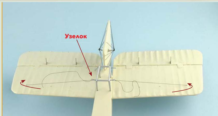
**34** Начинаем натяжение расчалок хвостового оперения. Возьмите достаточно длинный отрезок лески, обвяжите его конец вокруг опоры костыля, как показано на снимке, и закрепите его узелком. Пропустите леску сквозь крайнее переднее отверстие в стабилизаторе, затем проденьте ее через отверстие в переднем тандере рамы, слегка натяните и зафиксируйте узелком. Потом сделайте то же самое с другой стороны.
