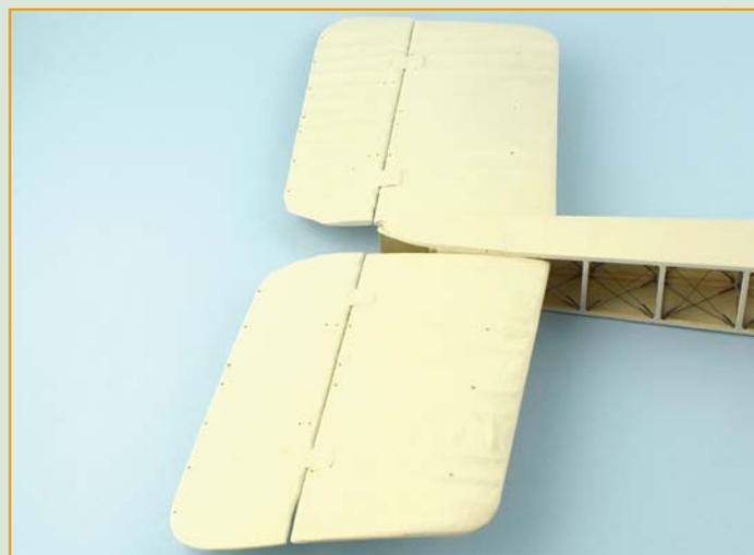
**18, 19** Вставьте отрезки в отверстия до упора и закрепите клеем. Затем проденьте их сквозь отверстия в обшивке фюзеляжа и приклейте к элементам каркаса. При этом выпуклая сторона стабилизатора должна быть обращена вверх. Потом наденьте на стержни с другой стороны вторую консоль стабилизатора и также закрепите ее клеем. Следите за тем, чтобы стабилизатор был параллелен нижнему крылу.
