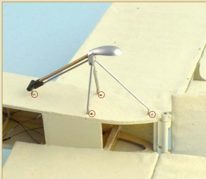
**31** В указанных точках просверлите в днище фюзеляжа отверстия диаметром 1 мм и вклейте в них костыль.
